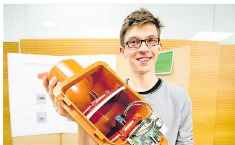
Jannis Egelhof vom Gymnasium Rittersberg zeigt seine mit Sensoren versehene Rückstauklappe. FOTO: VIEW
